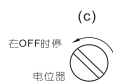
C 然后在检测体接近的状态下，把电位器向左旋转，在接近OFF时停下
